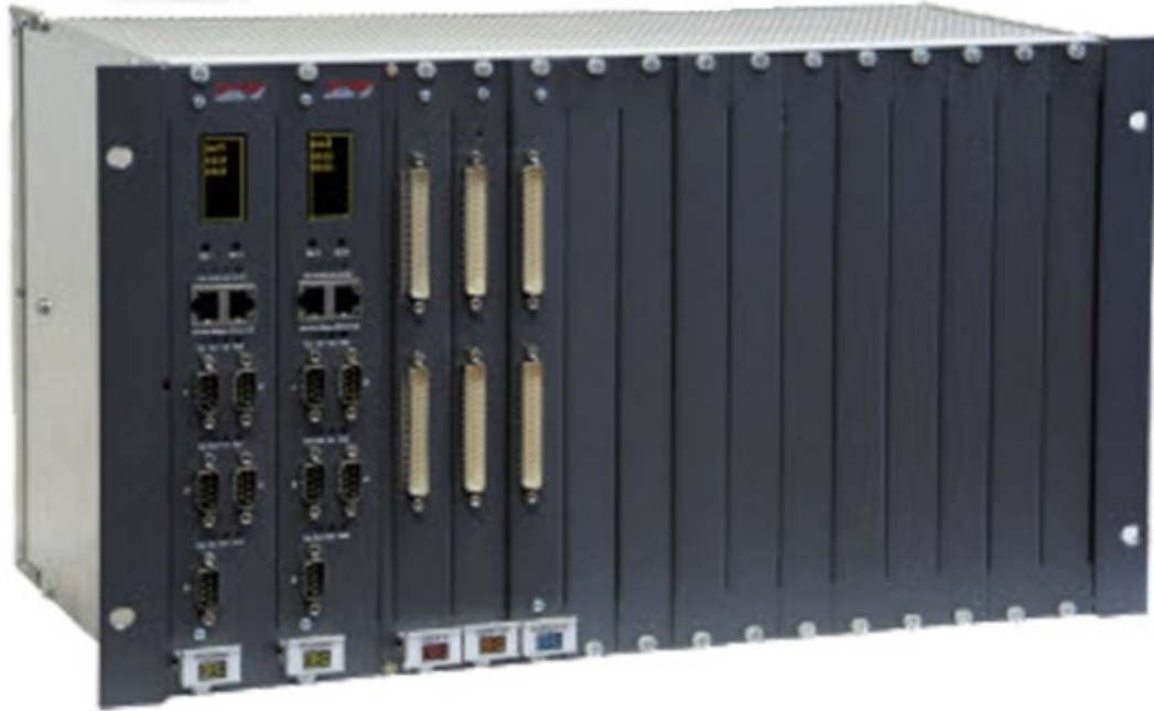
Hình 5.3: Hình ảnh một RTU sử dụng trong hệ thống điện
